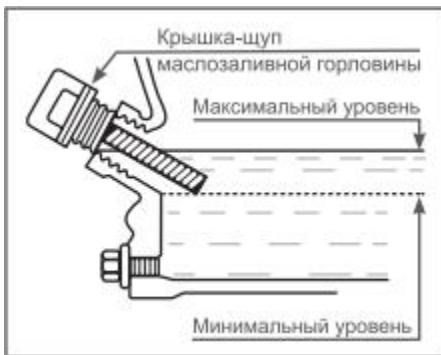
**ВНИМАНИЕ!** При запуске в работу нового устройства первая замена масла в двигателе производится через 5 часов работы. Вторая замена масла через 25 часов работы двигателя. Все последующие замены масла в двигателе производятся через каждые 50 часов работы двигателя.
