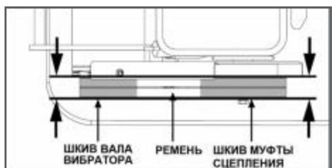
**7.** Установите на место защитный кожух ремней привода вибратора.
