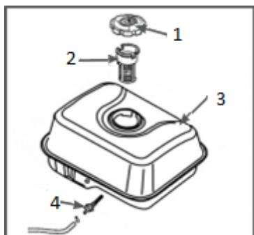
Регулярно проверяйте состояние топливного фильтра тонкой очистки\* и очищайте при необходимости. Для этого:
