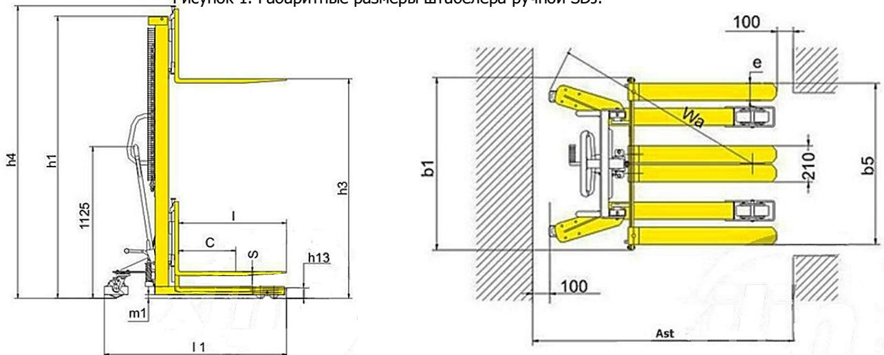
Рисунок 2. Габаритные размеры штабелера ручной SJJA20E.
