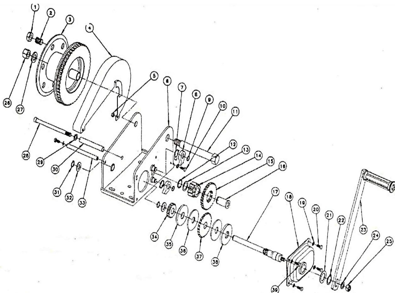
Рисунок 2. Взрыв схема лебедки ручной барабанной BHW.
